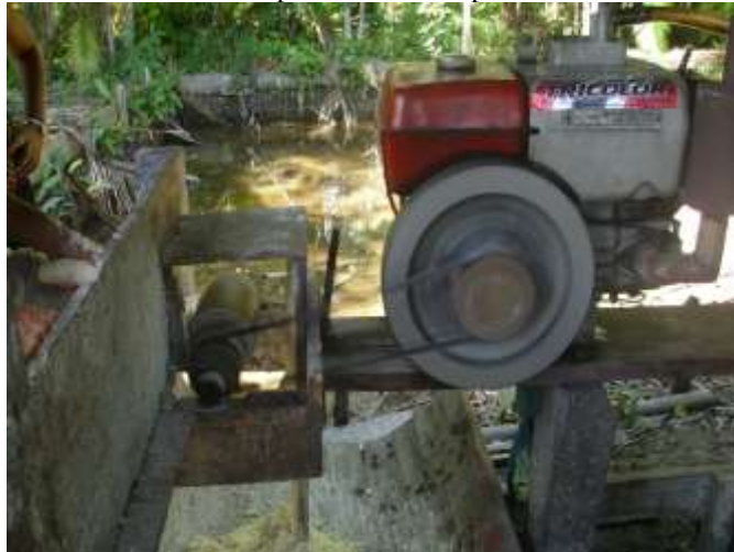
Foto 20 – Motor acoplado à tarísca para moer mandioca.
